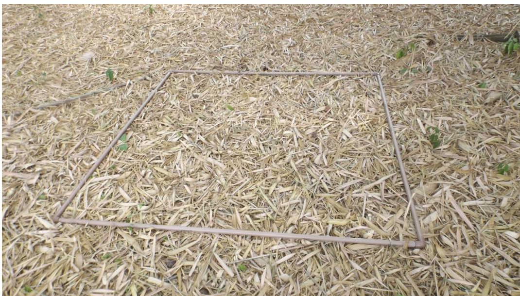
Figura 6. Gabarito utilizado nas coletas de material combustível superficial.
