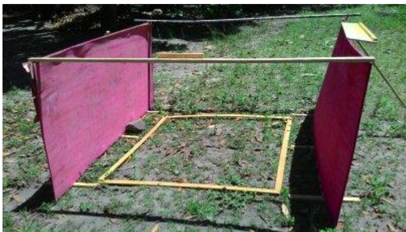
Figura 4. Mesa de combustão utilizada nas simulações de incêndios.
