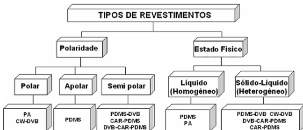
Figura 5: Esquema representativo da classificação dos revestimentos poliméricos (fase estacionária) comerciais para MEFS.
