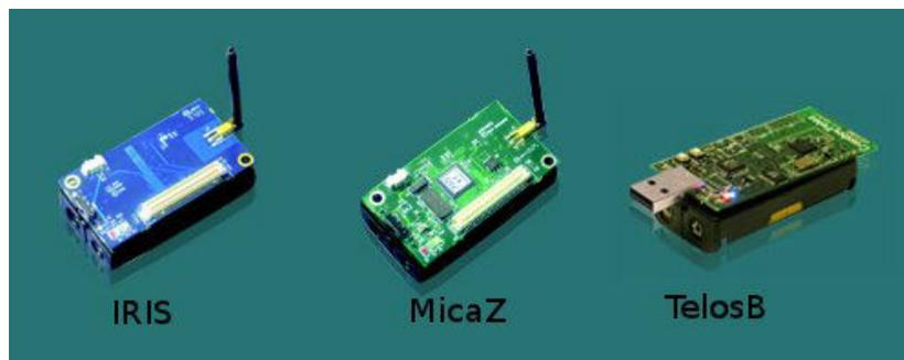
Figura 2.2: Exemplo de plataformas de sensores [Memsic 2012]
