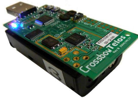
Figura 5.2: Sensor Telosb com processador MSP430 (BERKELEY.EDU, 2013).
