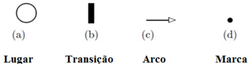
Figura 3.1: Componentes de uma Rede de Petri
