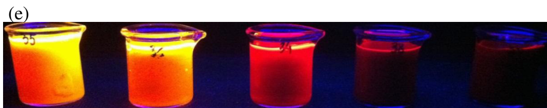
Figura 25. Síntese de NC de ZnCdTe-MW em diferentes tempos (5, 10, 20, 30, 40 min) (a) Espectros de Absorção dos NCs. (b) Espectros de emissão dos NCs excitados em 450nm. (c) Fotos dos NCs a luz ambiente. (d) Modelo esquemático do band gap de absorção e emissão de um fotón em função do tempo. (e) Fotos dos NCs excitados sob luz UV-365 nm.
