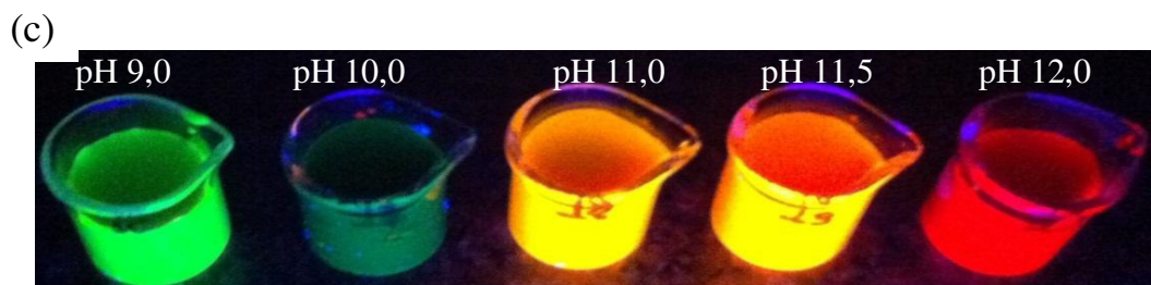
Figura 20. Síntese de NCs de ZnCdTe-Hidrotermal em diferentes pH (9.0, 10.0, 11.0, 11.5, 12.0) (a) Espectros de Absorção dos NCs. (b) Espectros de emissão dos NCs excitados em 450nm. (c) Fotos dos NCs excitados sob luz UV-365 nm.
