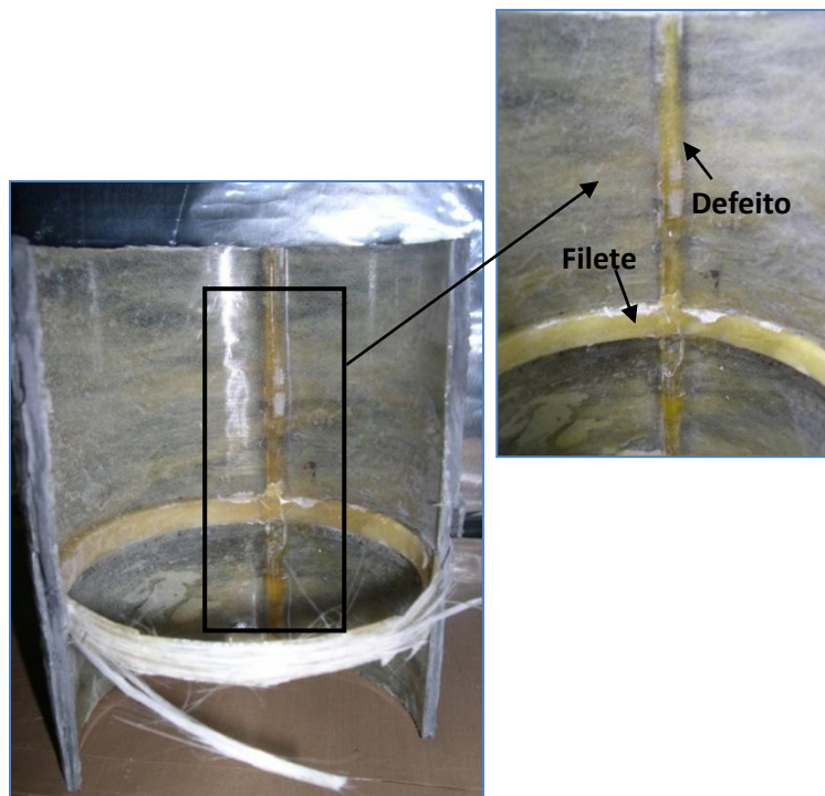
Figura 1 – Imagem da junta híbrida (fibra de vidro E/fibra de carbono/epóxi de cura a quente) perdida após o processamento.
