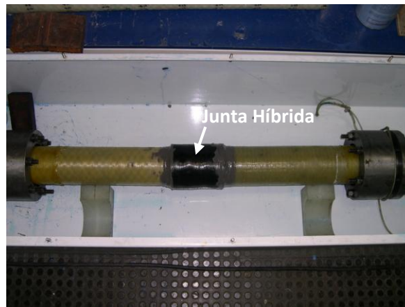
Figura 3 – Junta híbrida produzida e preparada para ensaio hidrostático.
