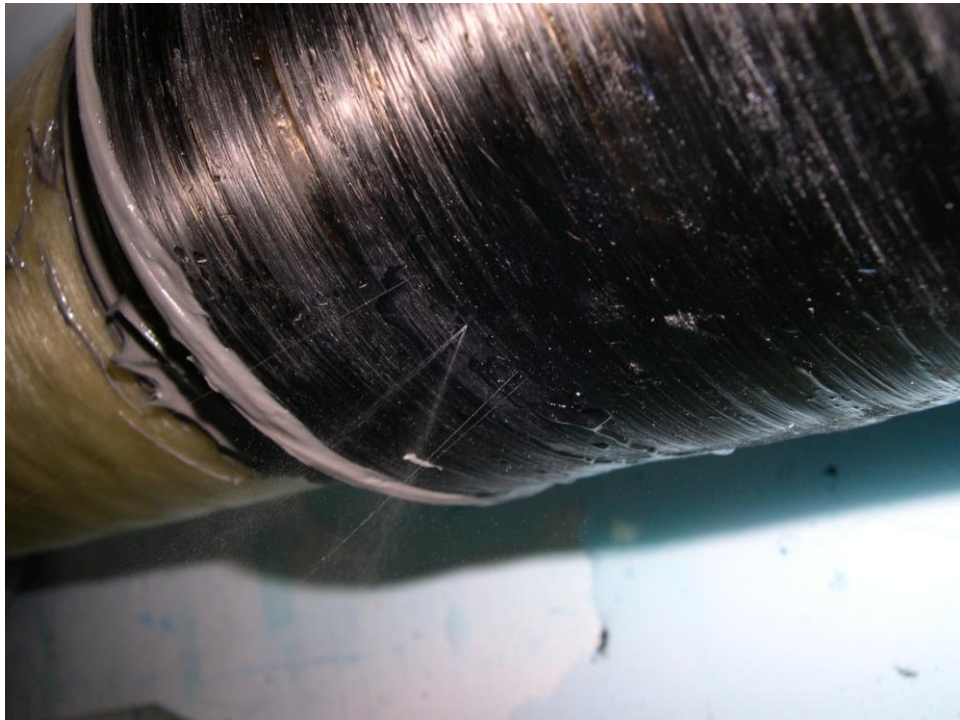
Figura 6 – Imagem da falha da junta híbrida durante o ensaio hidrostático.
