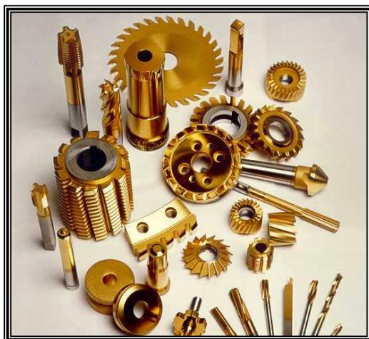
**Figura 1** – Exemplo de ferramentas de corte revestidas com nitreto de zircônio.
