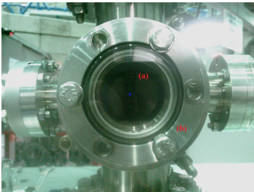
Figura 3.9 Foto do arranjo experimental para medidas de XAS na linha SXS. (a) porta-amostras, (b) câmara de amostras.
