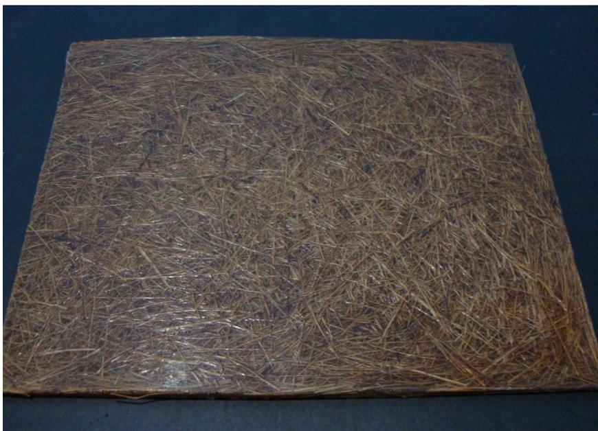
Figura 3.2 – Chapa típica de um compósito epóxi-fibra de coco com 30% de fibra.
