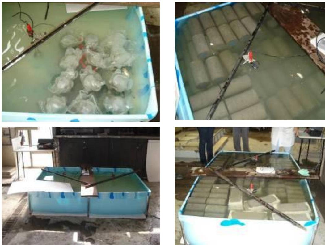
FIGURA 7: Adaptação de uma piscina plástica para funcionar como tanque de cura térmica, no laboratório da Escola Politécnica da USP, com aquecimento de água por resistência elétrica a  $(35 \pm 3^\circ\text{C})$  e controle por termostato. [5]
