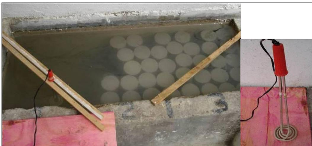
FIGURA 6: Detalhes da cura térmica rústica [6].
