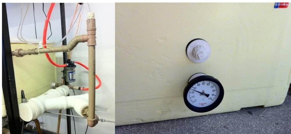
Figura 13: Orifícios para a conexão da caixa de aquecimento, sensor e termômetro.
