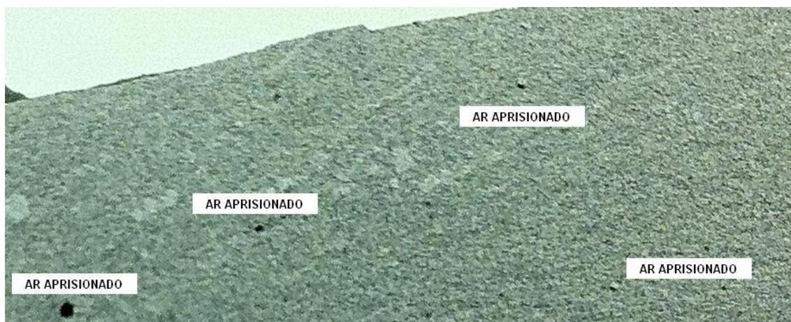
Figura 2: Ar aprisionado à pasta de cimento após preenchimento do molde.
