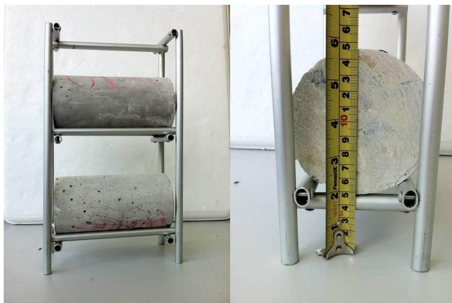
Figura 25: Gaiola individual para acomodação de dois corpos de prova de concreto e que garante uma distância de 50 mm em todas as suas direções.
