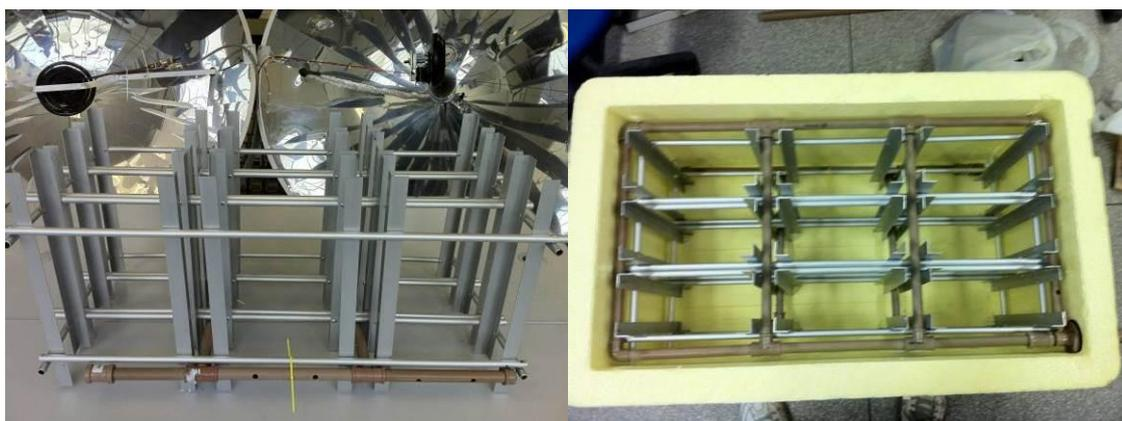
Figura 14: Grade geral à esquerda e grade geral acomodada no interior da caixa de isopor (reator híbrido solar).
