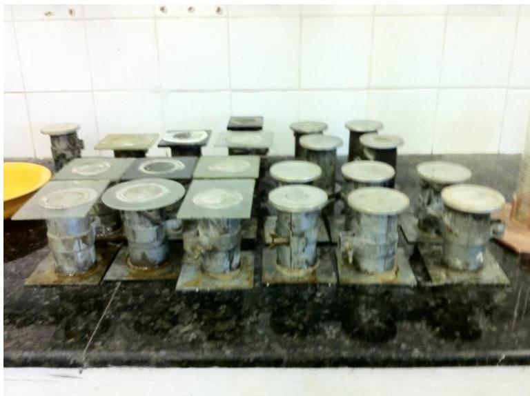
Figura 21: Formas de corpos de prova depois do adensamento e com placas de vidro no topo.
