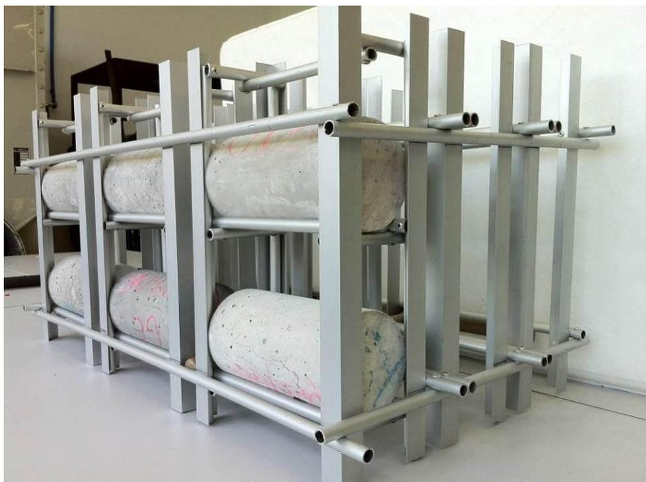
Figura 24: Gaiola geral de alumínio projetada para manter a separação dos pares de corpos de prova de concreto no reator solar híbrido, todos cilíndricos e com dimensões de 100 mm de diâmetro e 200 mm de comprimento.
