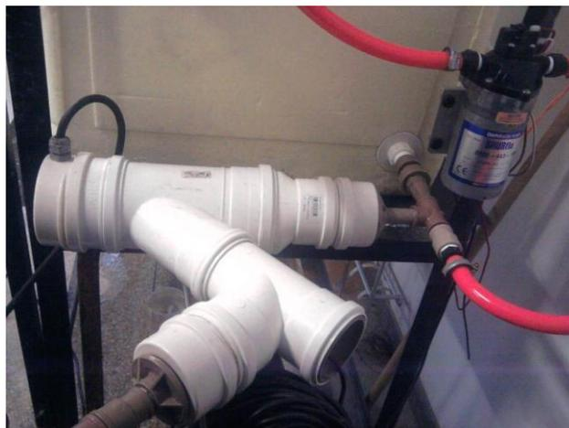
Figura 15: Caixa de aquecimento que acomoda uma barra aquecedora e um sensor de temperatura.
