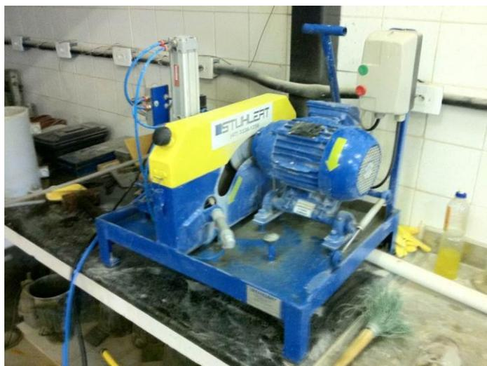
Figura 23: Máquina utilizada para retificar os topos dos corpos de prova de pasta de cimento.
