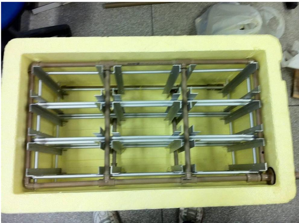
Figura 26: Vista superior do compartimento de corpos de prova de concreto, no reator solar híbrido.
