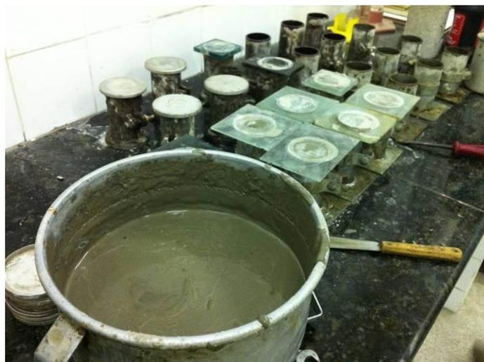
Figura 22: Pasta de cimento após a mistura de 15 min sendo colocada nas formas padrão que medem 100 mm de comprimento e 50 mm de diâmetro.
