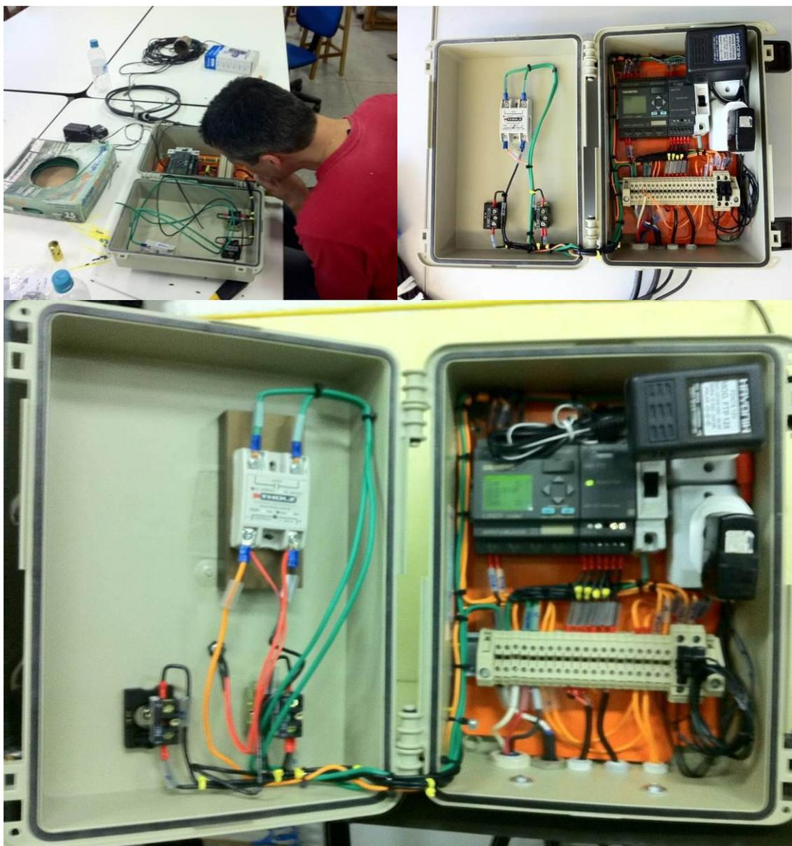
Figura 17: Montagem do painel de controle.
