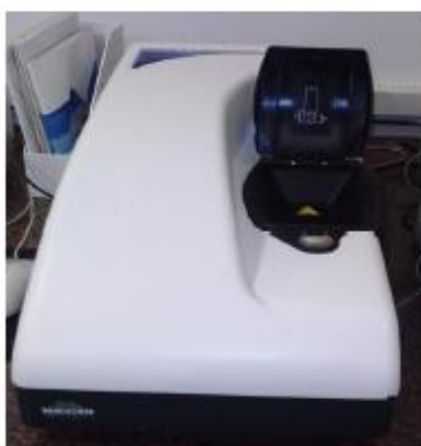
Figura 19: Equipamento Zetasizer ZS para análise de distribuição do tamanho de partícula
