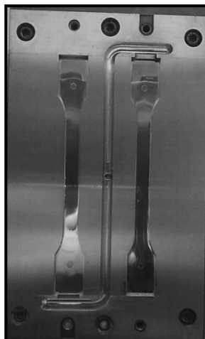
Figura 11 - Fotografia da disposição das cavidades dos corpos de prova no porta-molde conforme layout ISO A.
