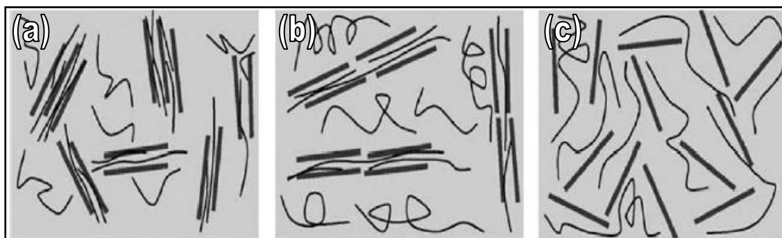
Figura 3. Representação esquemática dos tipos de estrutura de nanocompósitos.
