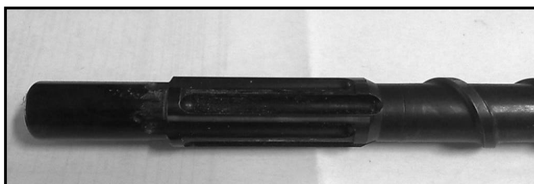
Figura 8 - Elemento de mistura MADDOCK na zona de dosagem da rosca.
