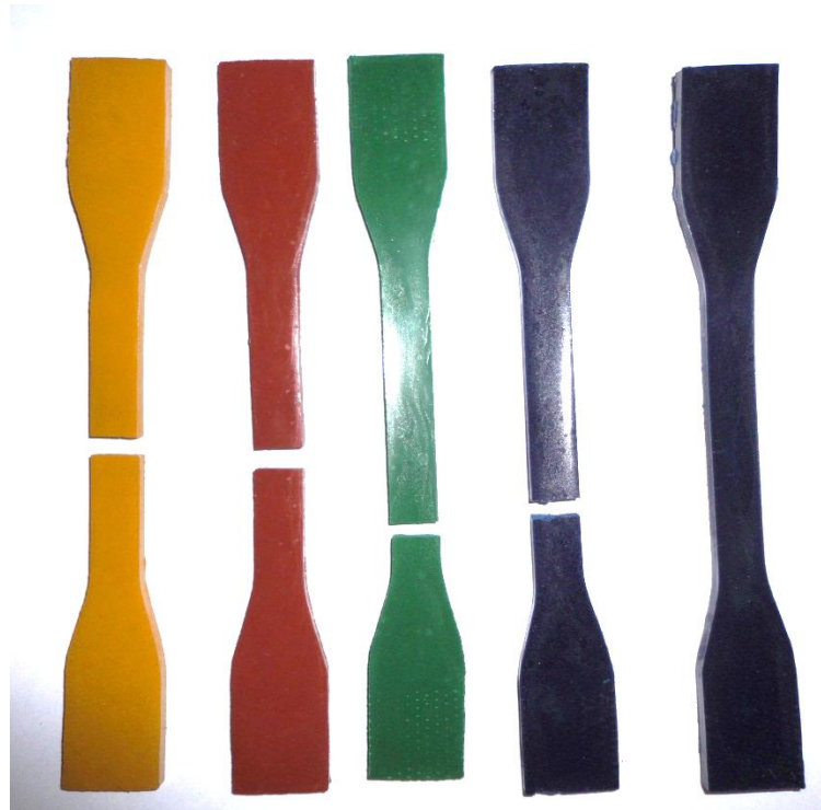
Figura 7: Corpos de prova seguindo a norma ISO 527-2B.
