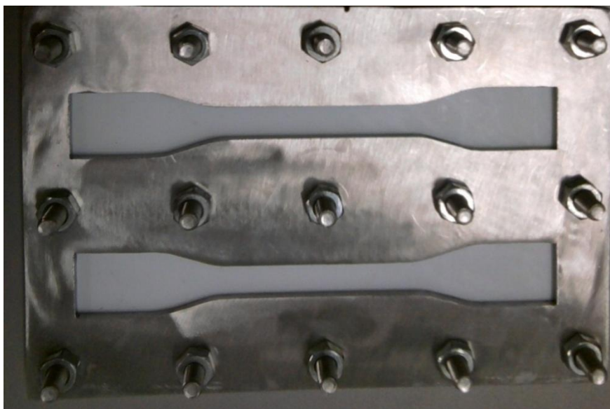
Figura 10: Molde de inox fabricado de acordo com a norma ISO 527-B
