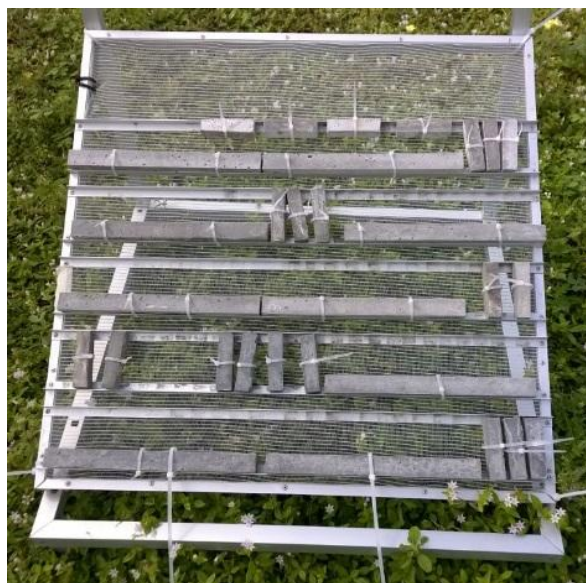
Figura 3.5. Corpos de prova expostos ao ambiente natural externo.
