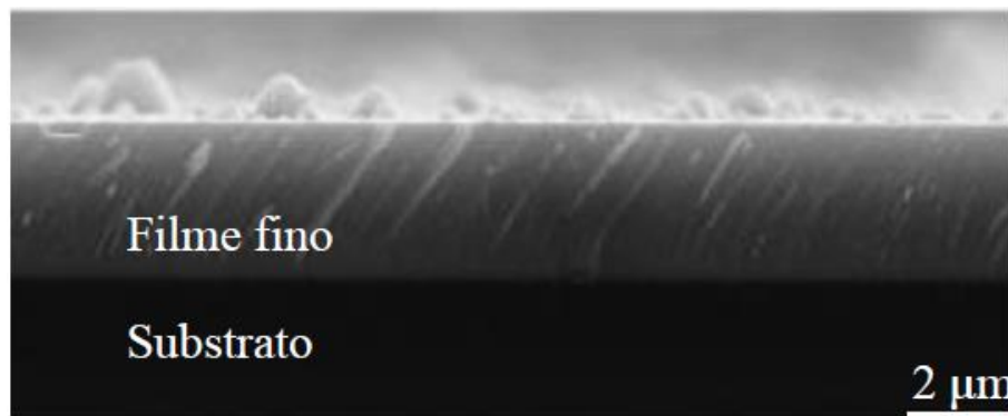
Figura 1: Seção transversal de um filme fino de NbAlN depositado em substrato de silício (Adaptado de FRANZ, 2010).
