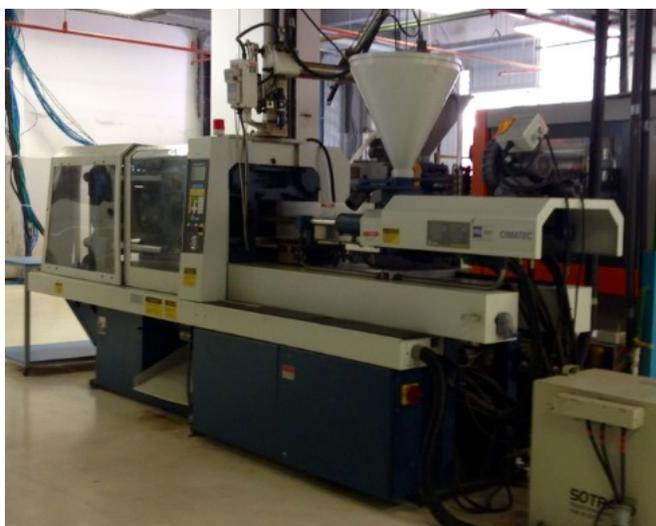
Figura 5.2: Injetora da marca Romi, modelo PRIMAX 100R (CIMATEC-BA).
