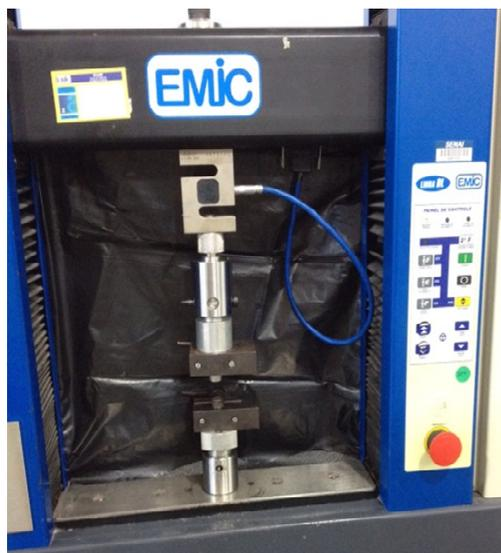
Figura 5.9: Máquina universal de ensaio da marca Emic, modelo DL 2000.
