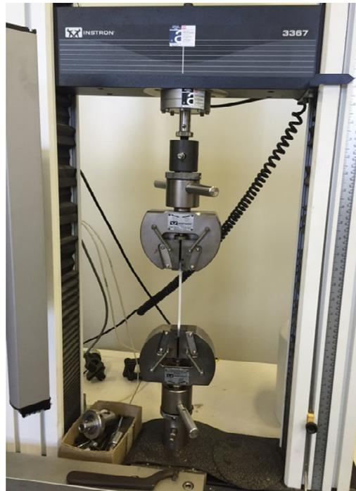
Figura 5.8: Máquina universal de ensaios Instron 3367.
