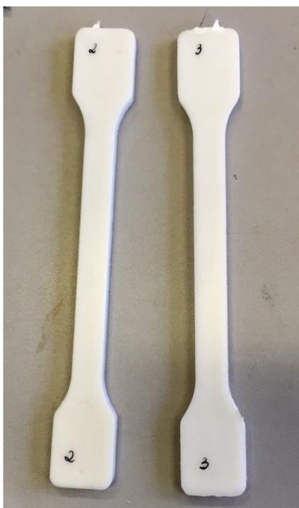
Figura 5.1: Corpos de prova de tração obtidos por injeção.
