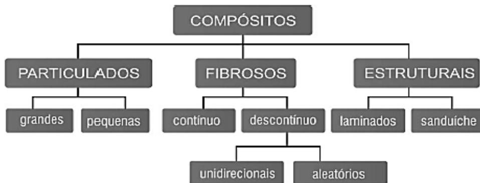
Figura 3.9: Esquema de classificação para vários tipos de compósitos. Fonte: [11].
