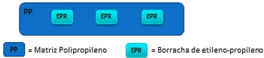
Figura 3.10: Representação da estrutura molecular do PP copolímero heterofásico.
