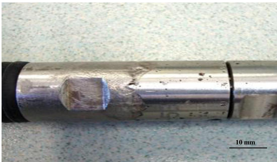
**Figura 5.18** - Danos por corrosão localizada (pites) e por perda de massa na região da extremidade da válvula causada pela ação da água corrosiva dos poços de injeção. Amostra retirada do CP-1463 com 44 dias do poço.
