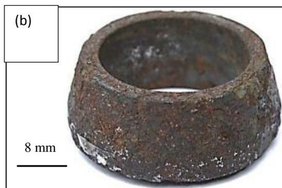
**Figura 5.12** - Peças danificadas da válvula de AISI 410, retirada do SZ-382 que durou 42 dias em operação até os danos: (a) luva do *latch*; (b) anel trava.
