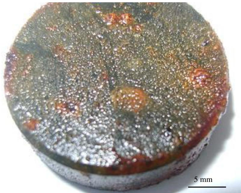
**Figura 5.21** - Amostra do aço AISI 410T com produtos de corrosão aderidos devido à agressiva corrosão com o meio.
