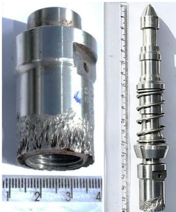
**Figura 5.19** - Danos na válvula construída de AISI 316, retirada do poço CP-463 após 61 dias de uso. Dano com aspecto rugoso e perda de material.
