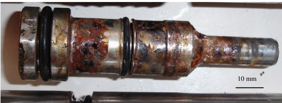
**Figura 5.15** – Danos no pistão da válvula do AISI 410, retirada do poço CP-1008, após 37 dias de uso.
