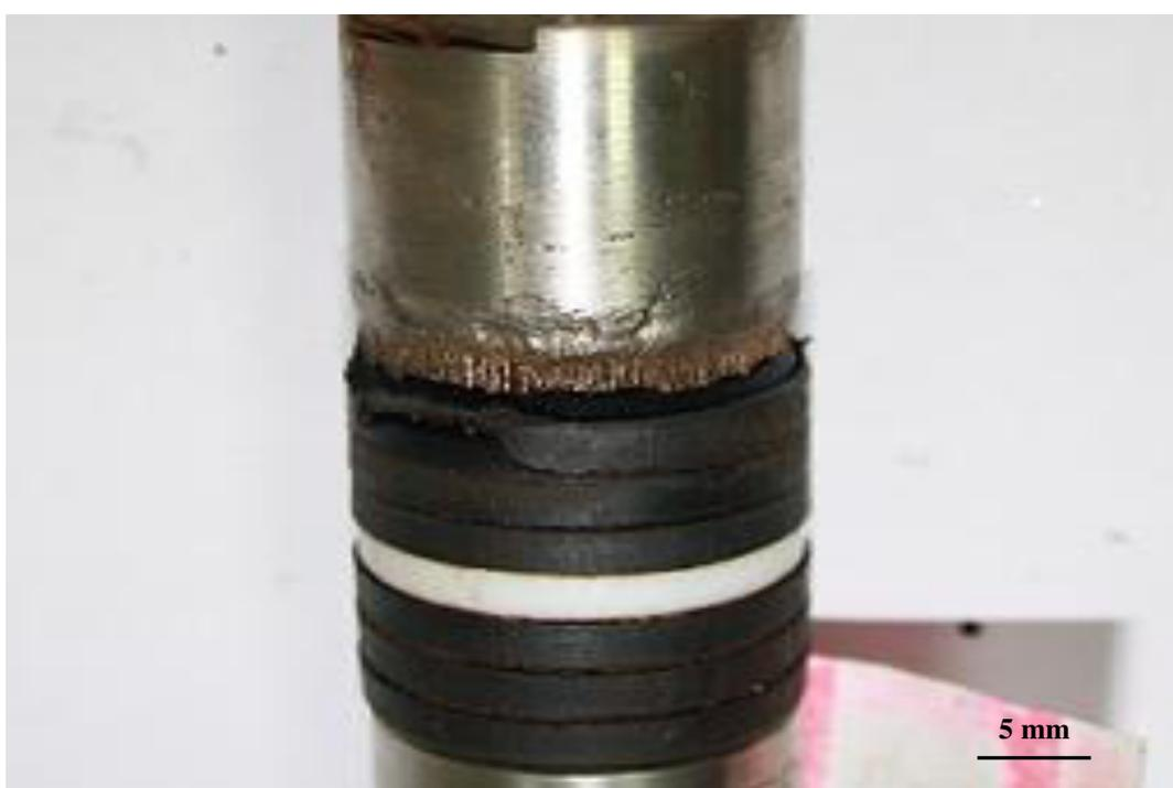
**Figura 5.16** - Danos em superfície de componente fabricado em aço AISI 316, constituído de marcas longitudinais típicas de reação com eletrólito. Válvula extraída do poço CP-1494 após 56 dias de uso.
