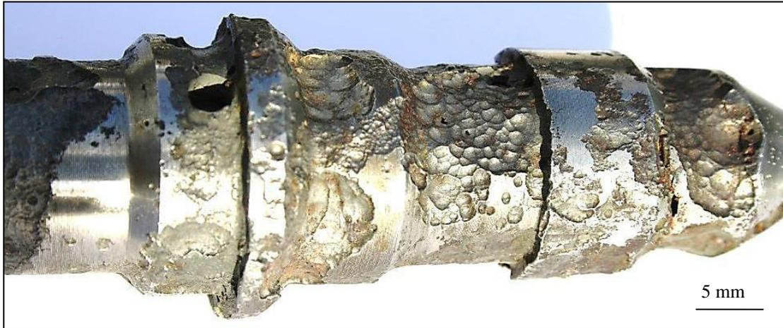
**Figura 5.11** – Superfície do *latch* do AISI 410 com danos severos retirado do poço SZ - 376 após 37 dias de operação.
