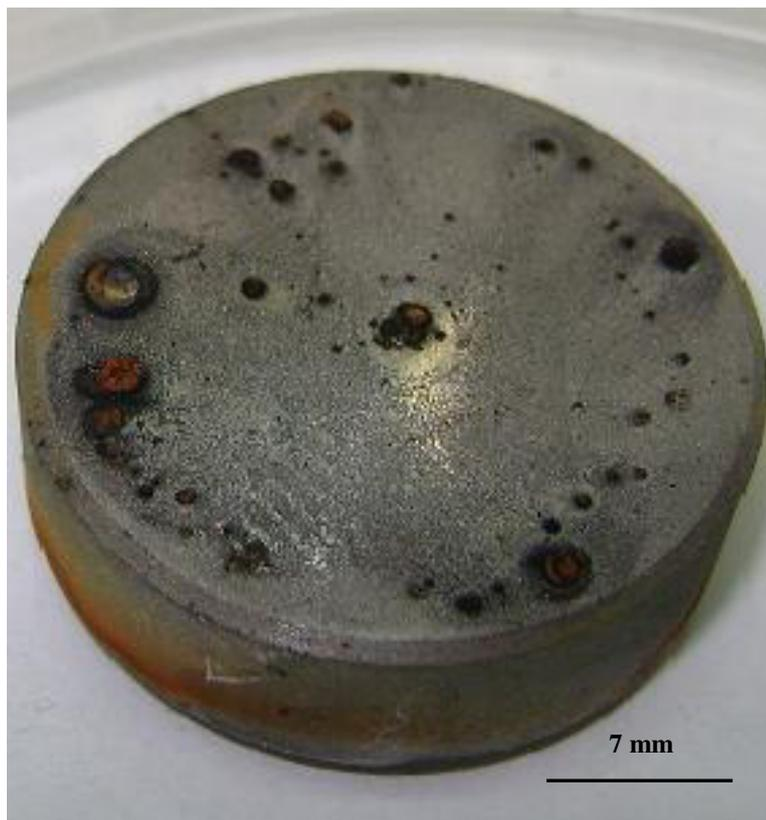
**Figura 5.23** – Cupom do aço inoxidável AISI 410S com danos causados pela corrosão por pites generalizado.
