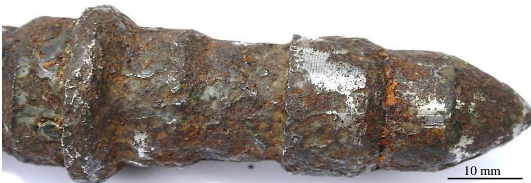
**Figura 5.14** - Desgaste na superfície do AISI 410 com danos de erosão e corrosão atuando simultaneamente. *Latch* extraído de válvula que durou 39 dias.
