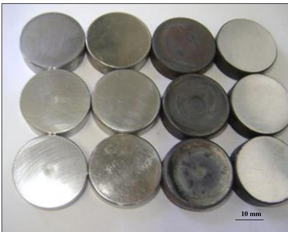
**Figura 4.2** – Imagem de 12 dos 28 cupons de AISI 316 e AISI 410S para os ensaios em laboratório.
