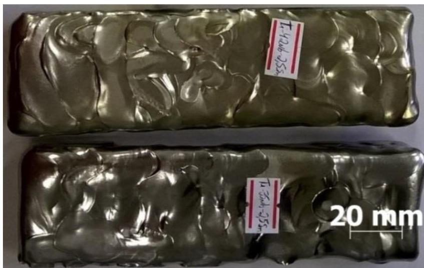
**Figura 19.** Dois dos lingotes de 280 g produzidos no forno de fusão.
