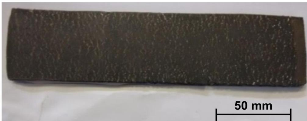
**Figura 21.** Imagem de uma chapa após o processo de laminação a frio.
