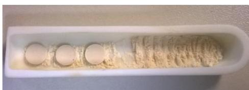
Figura 9 - Detalhe das pastilhas compactadas.
