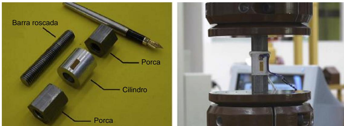
Figura 14 - dispositivo montado por KORIN e IPIÑA [24]
