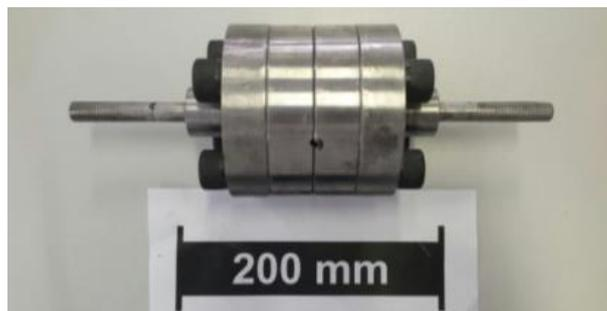
Figura 18 – dispositivo fabricado e montado para realização dos ensaios de resistência à fadiga em parafusos M8 classe 8.8.
