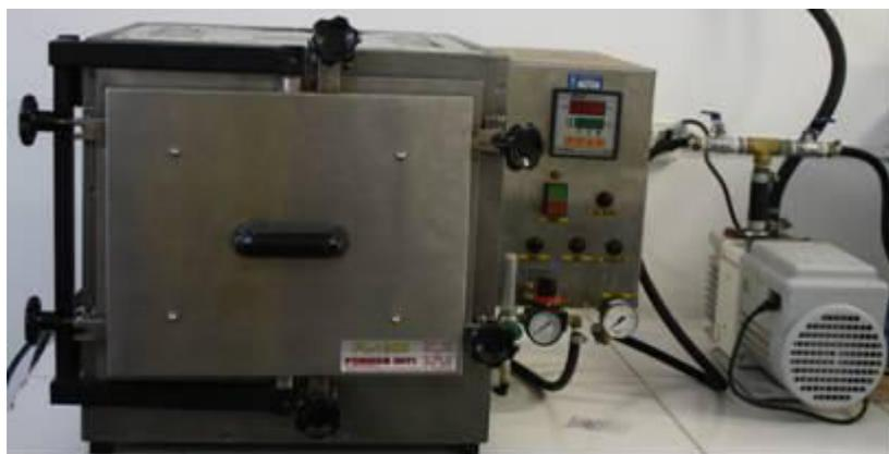
**Figura 4.5-** Forno a vácuo utilizado no tratamento térmico das ligas.
