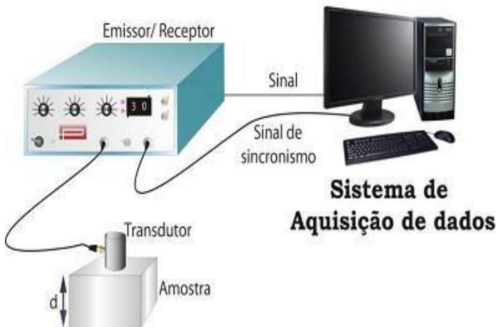
**Figura 4.15-** Diagrama esquemático do arranjo para determinação de constantes elásticas de ligas de titânio através de emissão e recepção de ultrassom (ALEIXO, 2009).
