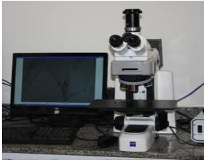
**Figura 4.9** - Microscópio óptico modelo Carl ZEISS Axio SCOPE A.1.
