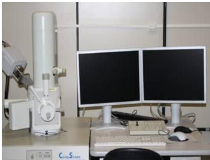
**Figura 4.10** – Microscópio eletrônico de varredura - JEOL JCM-5700.
