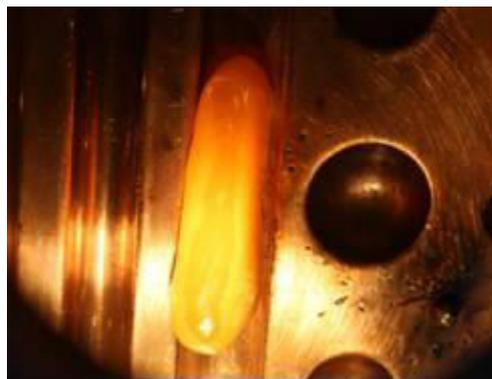
**Figura 4.3** – Lingote obtido após a fusão dos elementos de partida.
