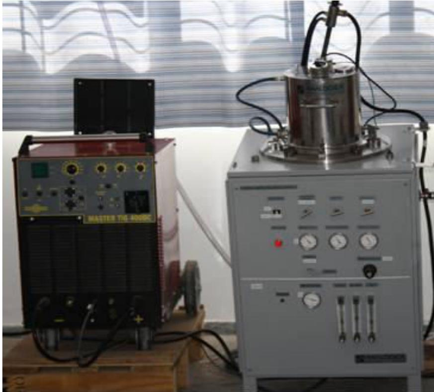
**Figura 4.2** – Forno a arco-voltaico utilizado para a obtenção das ligas.
