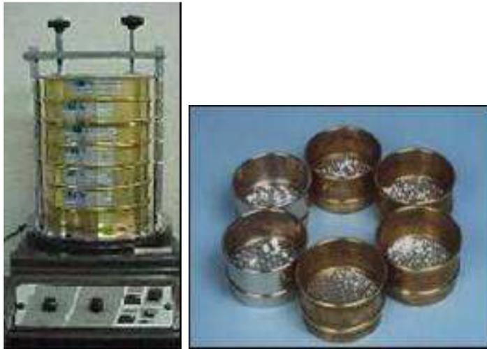
**Figura 3.** Peneiras montadas sobre o agitador (a); peneiras desmontadas contendo as partículas mastigadas após o peneiramento (b).
