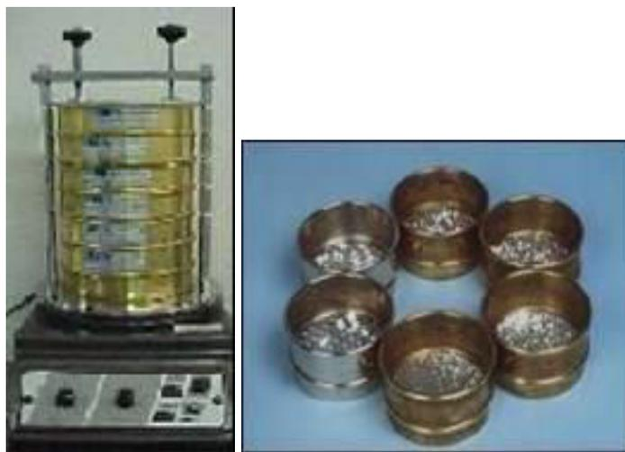
**Figura 5.** Tamises montadas sobre o agitador (a); tamises desmontadas contendo as partículas mastigadas após o peneiramento (b).
