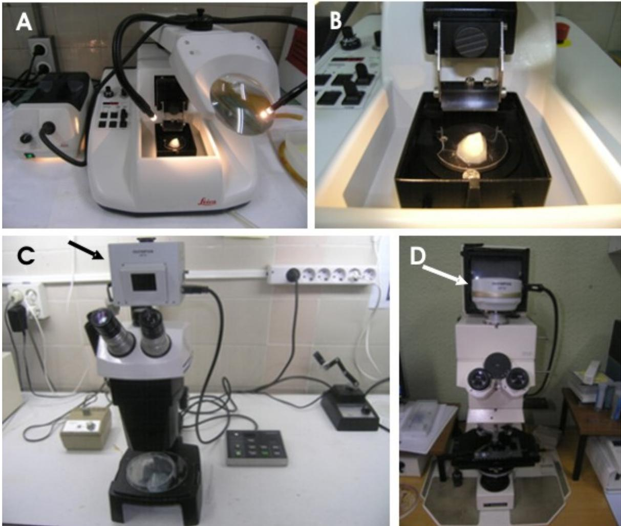
Figura 10: A, B – vibrátomo modelo Leica VT1000S, em B enfatiza-se a bandeja onde o cérebro, depois de incluído em ágar, é fixado para a realização dos cortes; C – lupa Olympus com resolução máxima de 80x, câmera digital acoplada (seta) (Olympus DP10); D – microscópio óptico e de fluorescência Axioplan da Zeiss, câmera digital OLYMPUS DP70 (seta).
