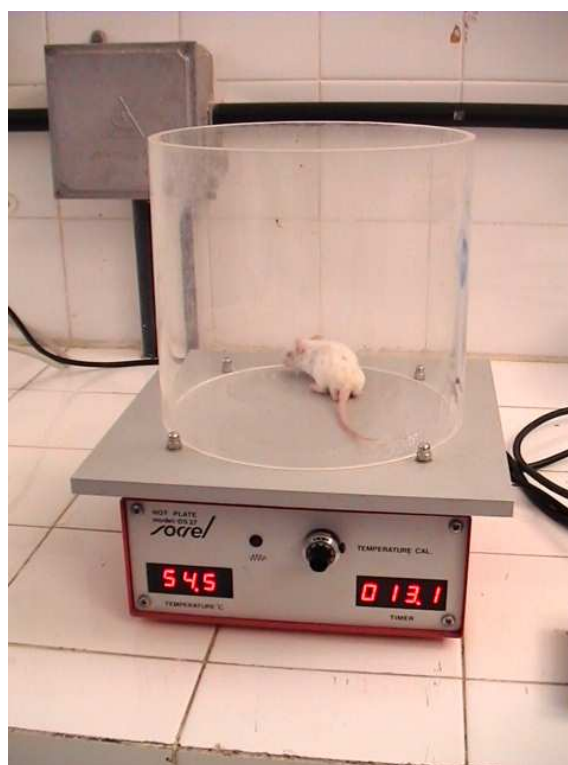
Figura 19b – Placa quente com camundongo em teste.
