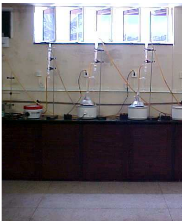
Figura 15a – Aparelho de Clevenger montado em série (cortesia de BLANK et al., 2005).
