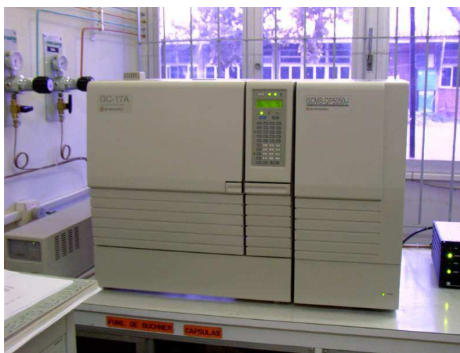
Figura 16 – Foto do CG/MS Shimadzu (cortesia de ALVES, 2005)
