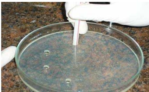
Figura 3. Método da difusão em Agar – técnica do poço.
