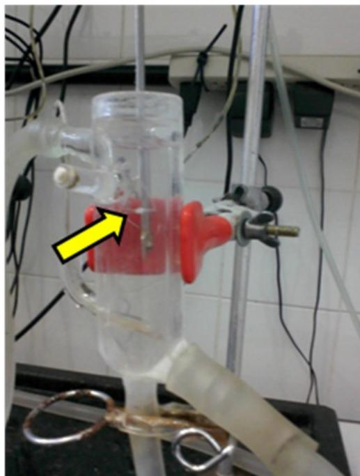
**Figura 8:** Anel arterial, disposto entre duas hastes, suspenso por linha de algodão e mantido em cuba para órgão isolado contendo solução nutritiva de Tyrode. Fonte: Luana Maynard (2011)
