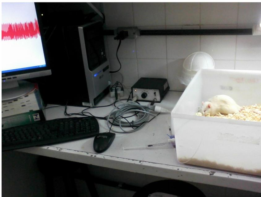
**Figura 5:** Sistema de aquisição de dados da PAM e FC em ratos.
