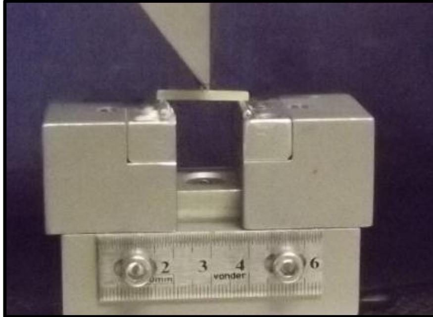
Figura 5 - Ensaio mecânico de resistência flexural e módulo de elasticidade
