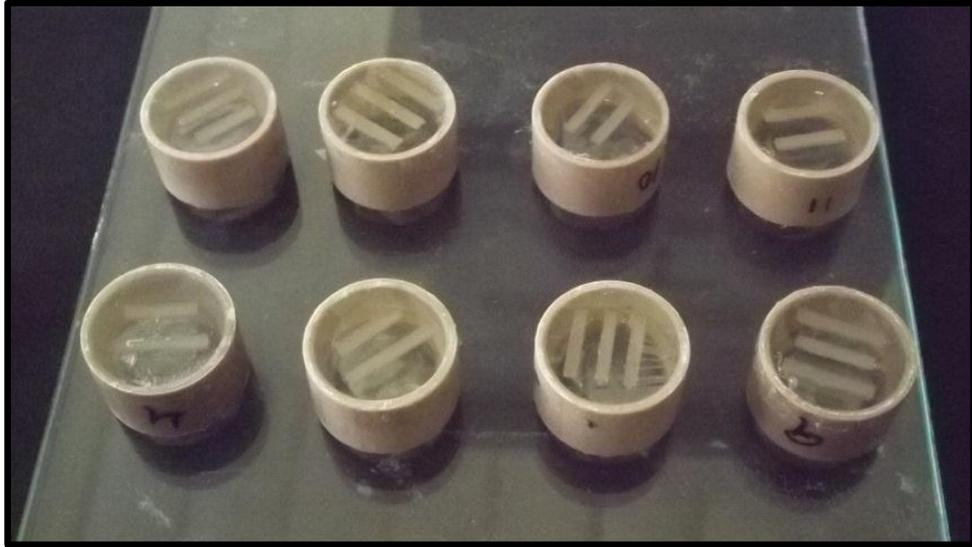
Figura 6 - Amostras embutidas para ensaio de dureza.
