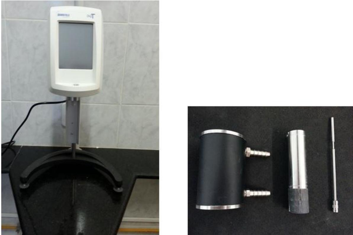
Figura 1 - Viscosímetro digital
