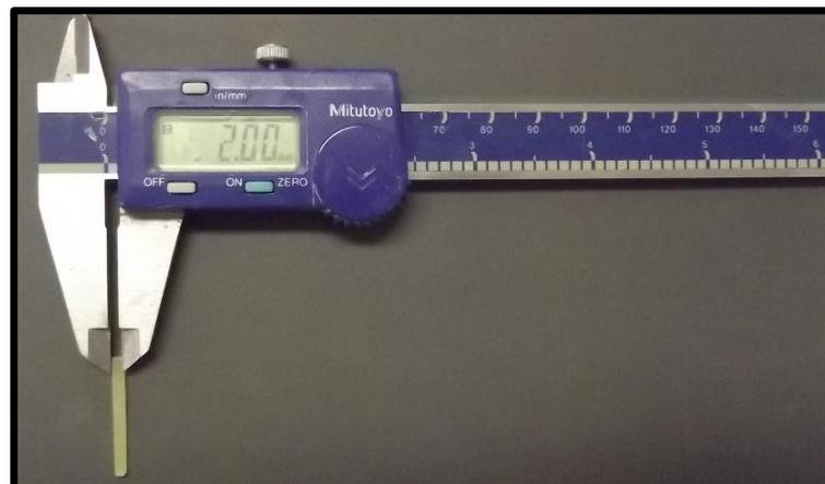
Figura 4 - Paquímetro digital para conferência das amostras.
