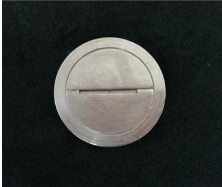
Figura 2 - Matriz metálica para preparação das amostras
