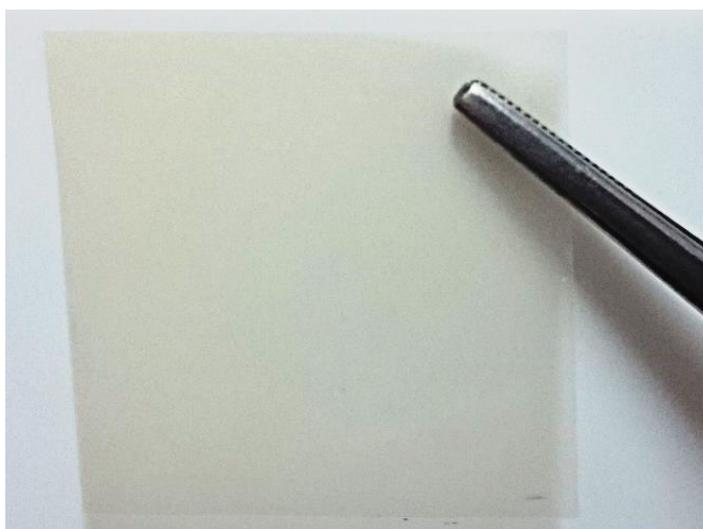
Figura 6: Memb/AU/Lip obtida pelo método de *casting* após a secagem.
