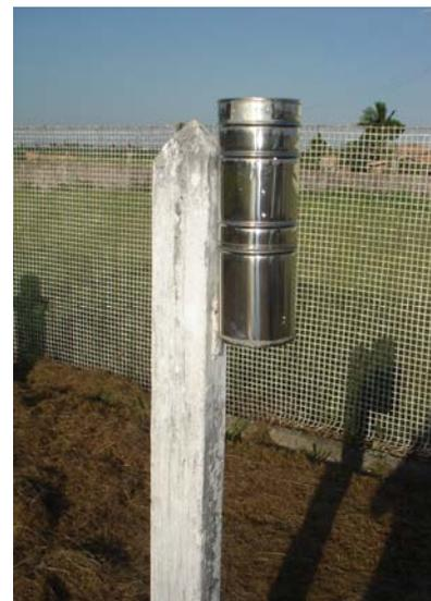
Figura 3.5 – Pluviômetro Convencional Não Padronizado
