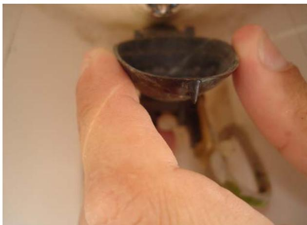
Figura 5.2 – Bâscula do Pluviômetro da Estação automática 1822 – Deagro-Boquim com sujeira.
