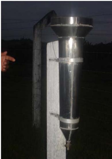
Figura 3.4 – Pluviômetro Convencional Padronizado
