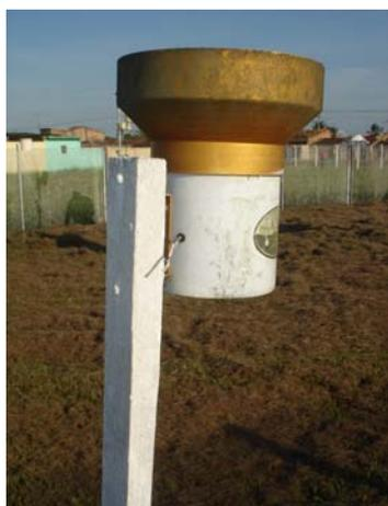
Figura 5.1 - Pluviômetro automatizado, localizado no posto da Deagro em Boquim.
