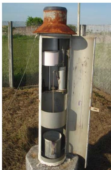
Figura 3.8 – Pluviógrafo
