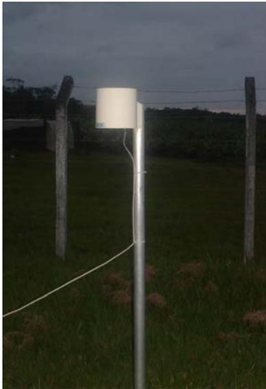
Figura 3.6 – Sensor Pluviométrico de uma Estação Automática
