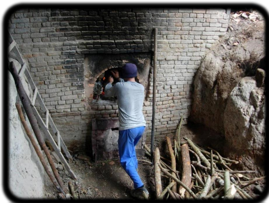
Figura 12- Abastecimento do forno com lenha para queima da telha.
