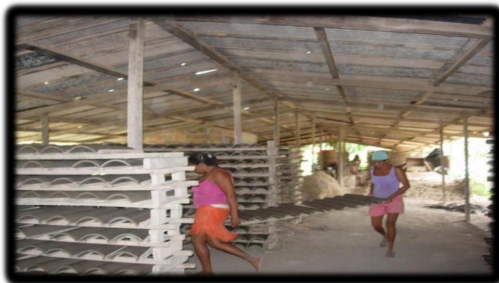
Figura 23 – Mulheres transportando telhas para as grades, local de secagem. Fonte: FIGUEIRÊDO, 2011, pesquisa de campo.
