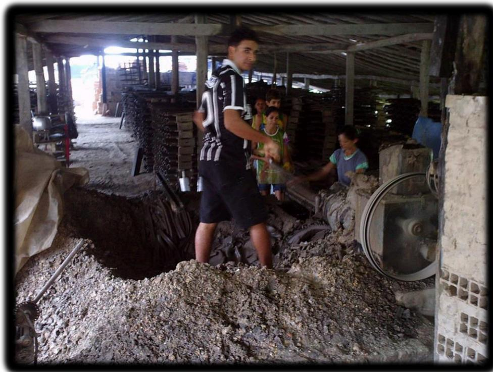
Figura 26- Selão sendo colocado na máquina para fabricação da telha.
