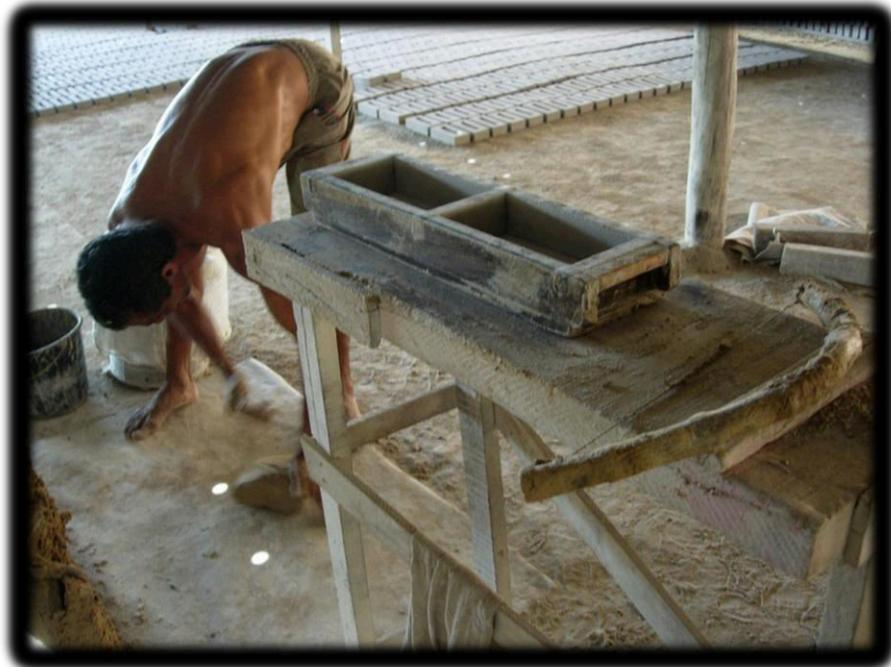
Figura 17 – Homogeneização do barro, preparação inicial para a produção do tijolinho.
