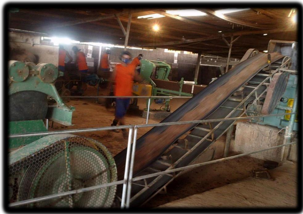
Figura 15- Máquina de processamento do barro para fabricação de bloco.
