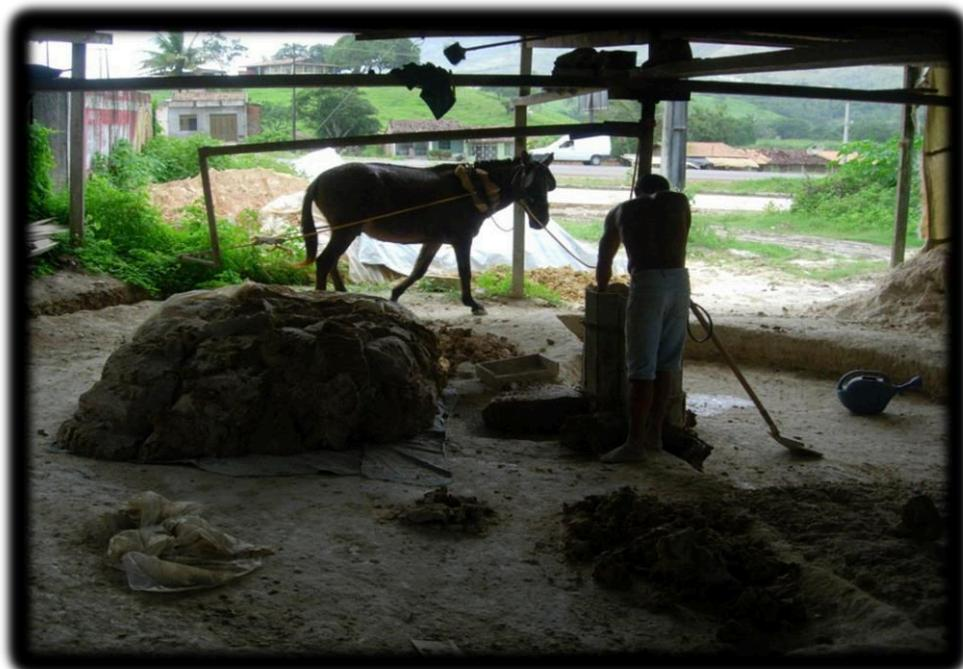
Figura 16- Mistura do selão e argila utilizando a tração animal.
