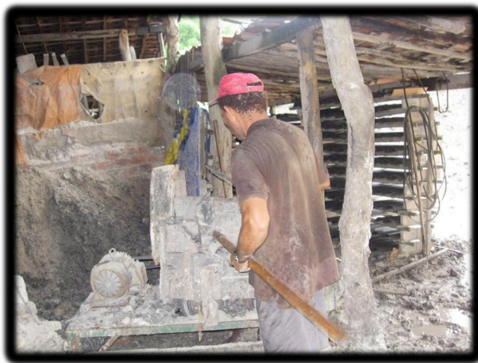
Figura 28 – Mistura do barro, etapa do processo produtivo da fabricação da telha.
