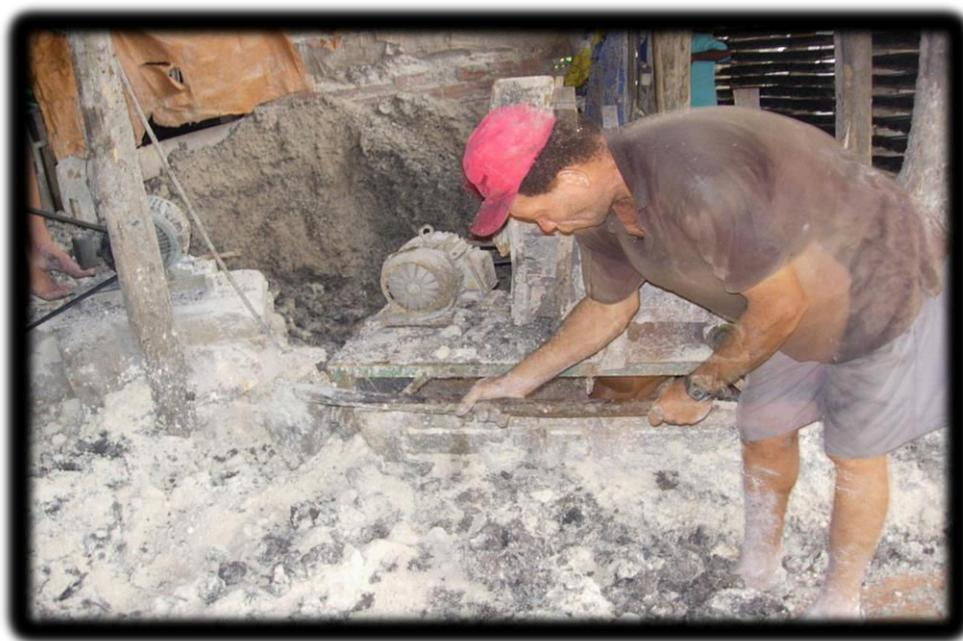
Figura 10- preparação e mistura do selão e argila, para a fabricação da telha.
