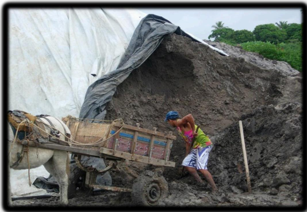
Figura 9- selão, matéria prima utilizada na fabricação (telhas, tijolinhos, e mistura para fabricação do bloco) Fonte: FIGUEIREDO, 2011, pesquisa de campo em 24/05/2011.
