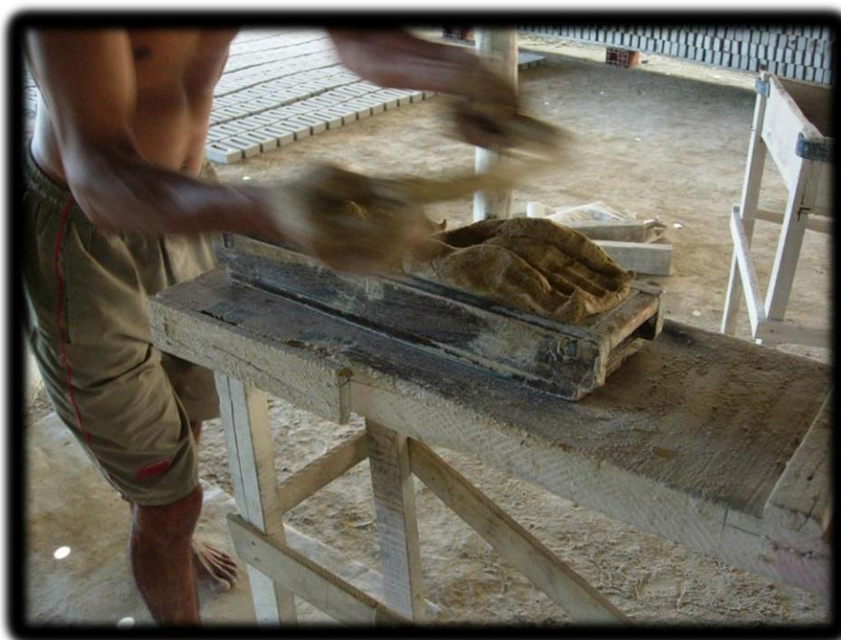
Figura 19- Etapa do processo produtivo dos tijolinhos, colocação na forma, e retirada do excesso de barro. Fonte: FIGUEIREDO, 2011, pesquisa de campo em 13/07/2011.
