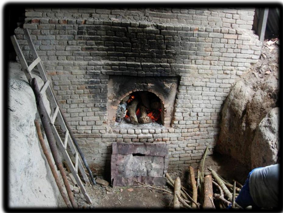
Figura 11- Forno de olaria utilizado para queima das telhas e tijolinhos.
