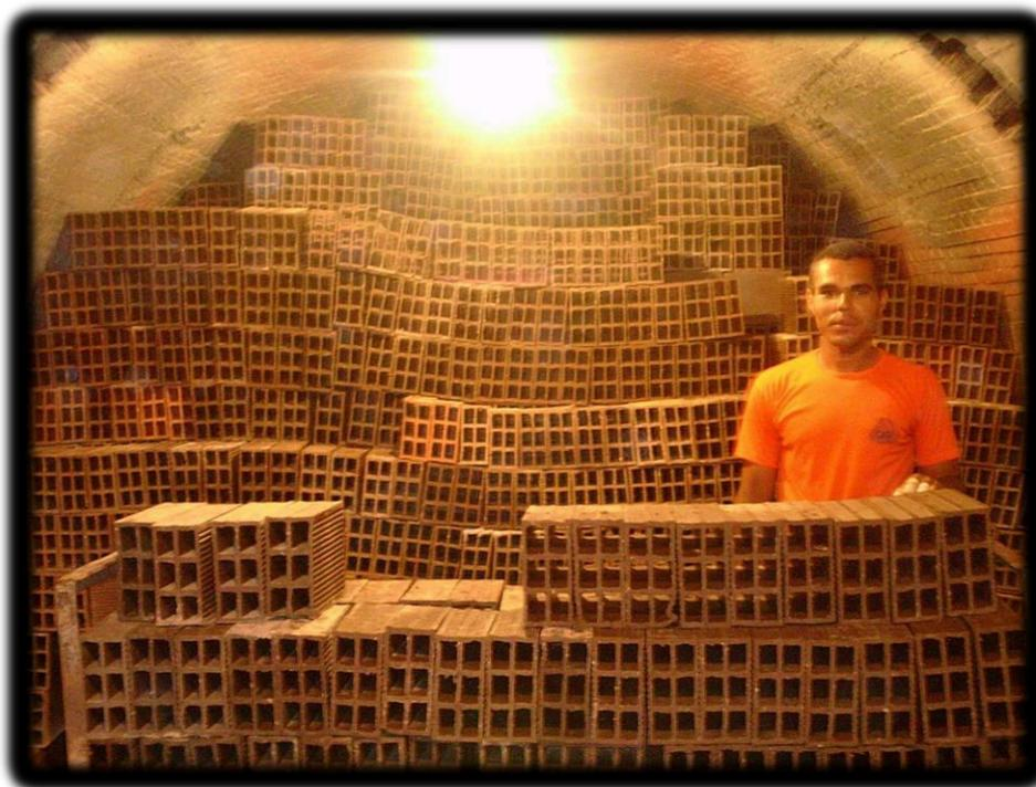
Figura 13- Abastecimento do forno de cerâmica com bloco para queima.
