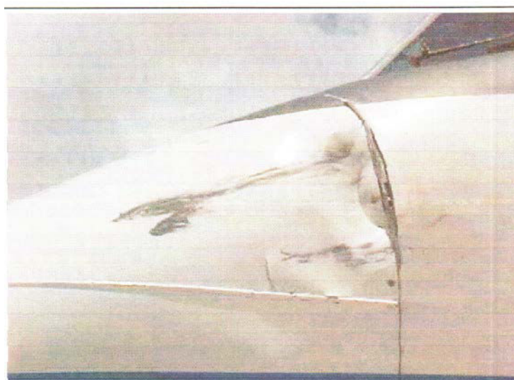
Fotografia 12: Colisão de aeronave da VASP com urubu em 05/02/2003. Fonte: INFRAERO.
