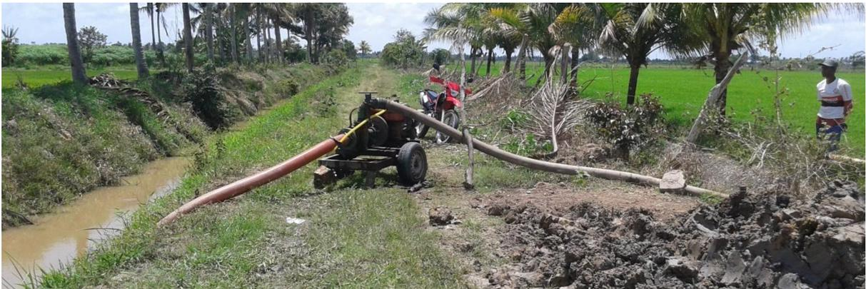
Figura 30 - Utilização de bomba a motor diesel para transferir água de drenagem para o lote.
