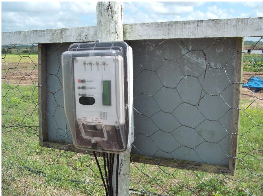
Fotografia 2. Instalação do equipamento no campo, dentro do cercado da estação meteorológica.
