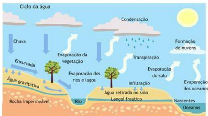
**Figura 2.1** – Esquema hidrológico aplicado à encosta de uma bacia hidrográfica
