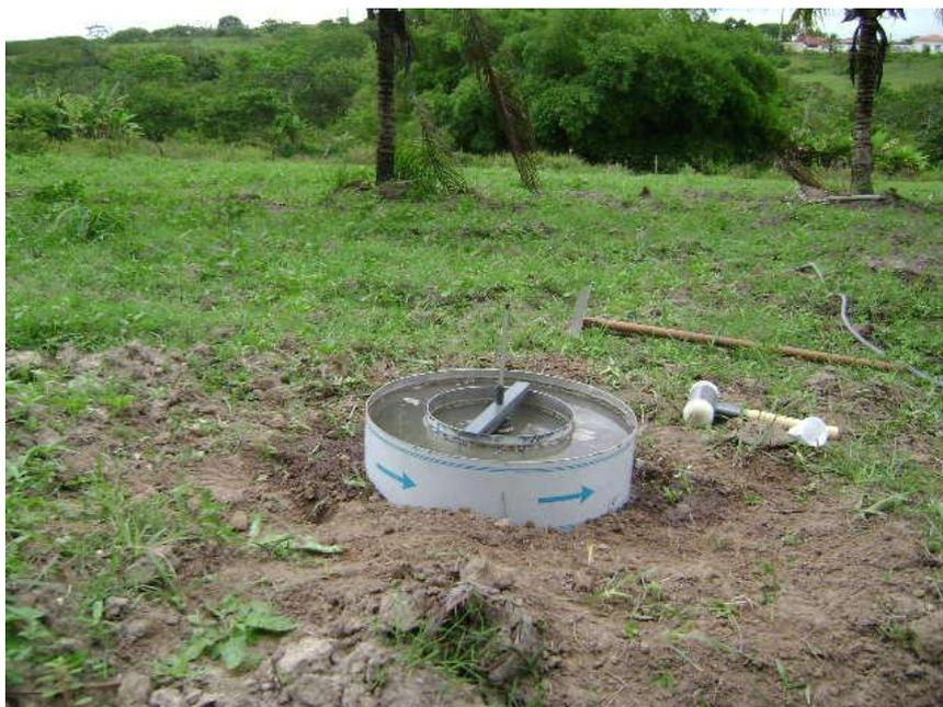
**Figura 4.2:** Determinação da velocidade de infiltração da água no solo. (Fonte: Marinoé Gonzaga da Silva).
