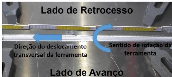
Figura 23. Acabamento superficial do cordão de solda da junta TWB-I-1
