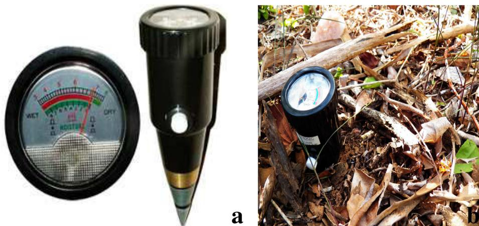
**Figura 7.** (a) Imagem do medidor de pH e umidade do solo INSTRUTHERM modelo PH-2500; (b) Representação da posição do equipamento para aferição das medições.
