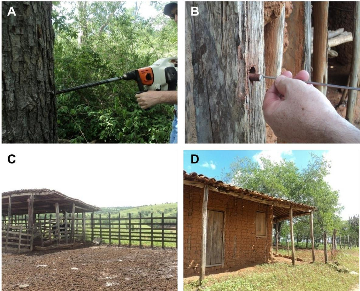
Figura 4: A – coleta não-destrutiva com trado motorizado; B – extração de amostra após perfuração da madeira; C e D – exemplos de construções onde foram coletadas amostras de madeira, curral e casa de taipa da propriedade. Amostras coletadas nos meses de jun/jul de 2013 na Fazenda São Pedro, município de Porto da Folha/SE, por Danielle Cardoso e Claudio Lisi.
