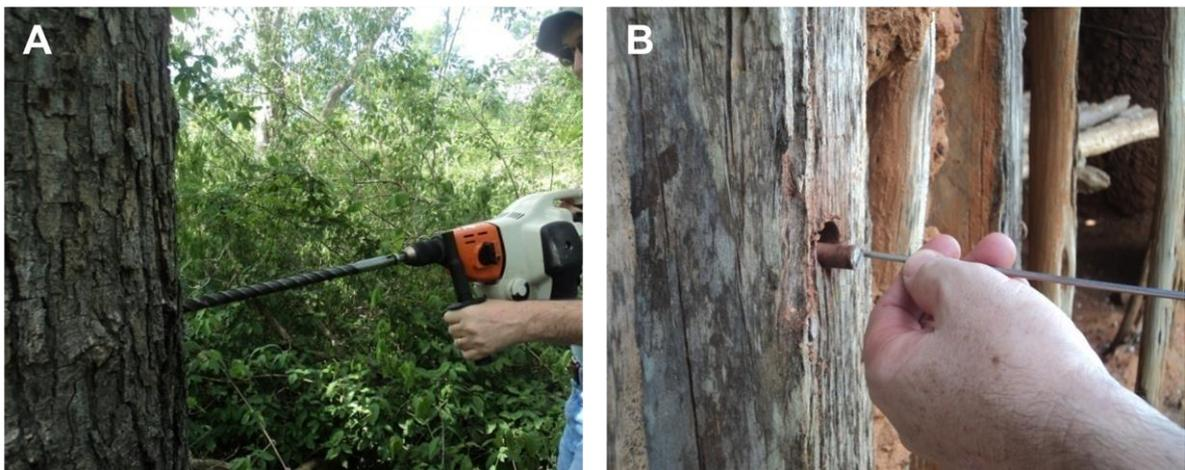
Figura 4: A – Coleta não-destrutiva com trado motorizado; B – extração de amostra após perfuração da madeira. Coletas realizadas nos meses de jun/jul de 2013, na Fazenda São Pedro, município de Porto da Folha/SE, por Danielle Cardoso e Claudio Lisi.
