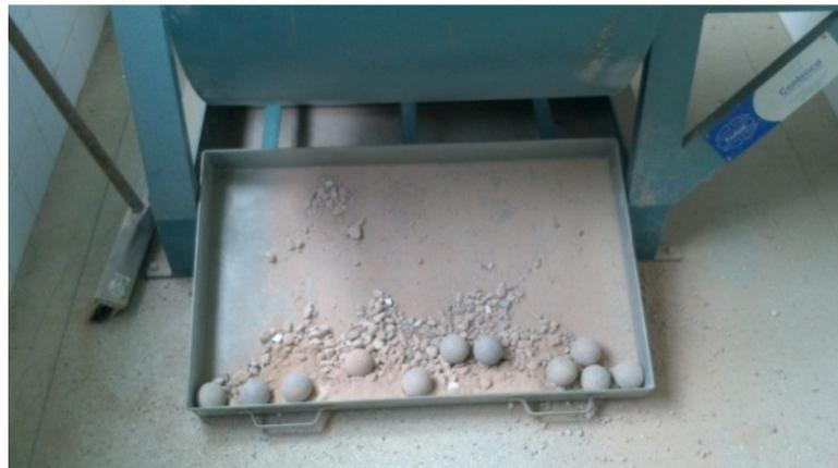
Figura 35 – Amostras de ARG 2 (à esquerda) e ARG 1 (à direita) após o ensaio de abrasão.
