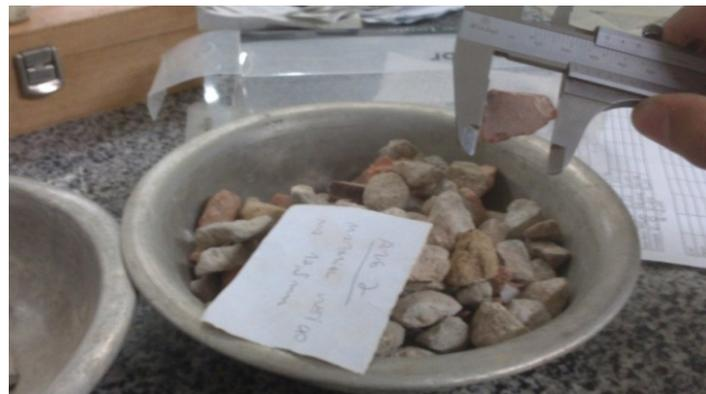
Outro parâmetro analisado foi o percentual de perda de massa por abrasão dos ARGs. Como os ARGs utilizados não se enquadraram nas graduações estabelecidas pela norma, foram separados cerca de 5 kg de uma mesma fração granulométrica. Para o ARG1 foi utilizado o material que passava na peneira com malha de abertura 9,5 mm e ficava retido na de 6,3 mm. Já para o ARG2, foi utilizado o material que passava na peneira de abertura 19,0 mm e ficava retido na malha de 12,5 mm.
