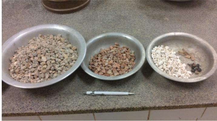
Figura 31 – Separação conforme a natureza dos constituintes do ARG2.
