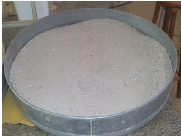
Figura 18 – Agregados reciclados graúdos (ARGs) coletados.
