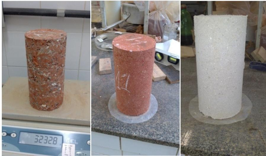
Figura 44 – Etapas de preparação e acondicionamento dos CPs na câmara triaxial.
