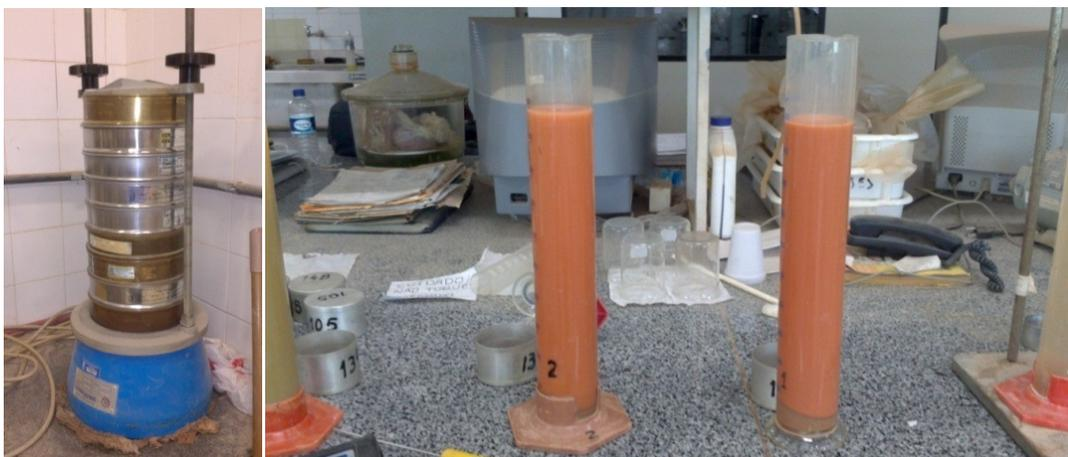
Para a fração de solo que passa na peneira com abertura de malha de 0,42 mm (nº. 40), foram determinados os limites de consistência através dos ensaios de Limite de Liquidez (LL), conforme mostra a Figura 26, e de Limite de Plasticidade (LP), utilizando-se as normas DNER-ME 122 (1994) e DNER-ME 082 (1994), respectivamente. Após a obtenção desses dois parâmetros obteve-se o índice de plasticidade (IP).
