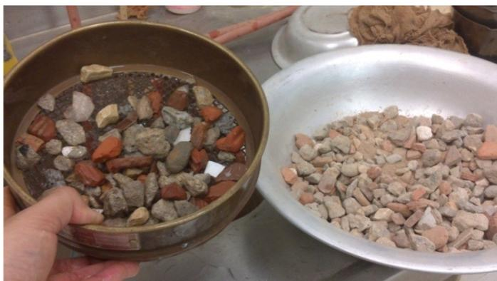
Figura 30 – Separação conforme a natureza dos constituintes do ARG1.
