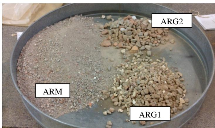
Para a preparação dos agregados reciclados, foram realizadas as etapas de secagem ao ar seguida da separação em parcelas reduzidas, usando-se um separador mecânico, reduzindo as amostras em quantidades adequadas para a realização dos ensaios.
