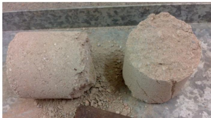
Figura 46 – Extração de material do terço médio do CP da amostra A10 para determinação do teor de umidade.
