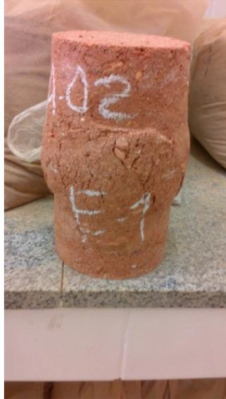
Figura 42 – Foto dos corpos de prova em cura na câmara úmida.
