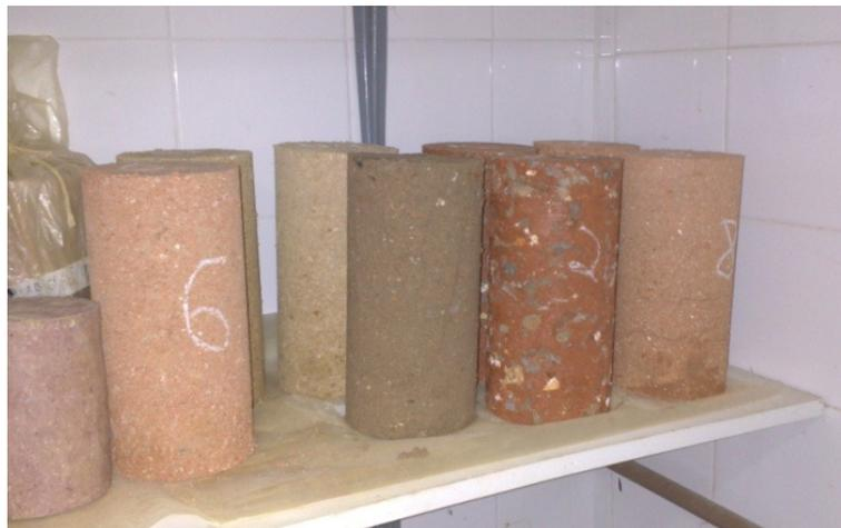
Após o período de cura de sete (7) dias em câmara úmida (Figura 43), os CPs foram preparados e acondicionados na câmara triaxial, conforme apresentado na Figura 44.
