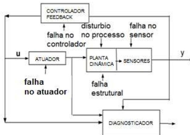
Figura 3.2: Esquema de um diagnosticador genérico (adaptado de Venkatasubramanian et al, 2002)
