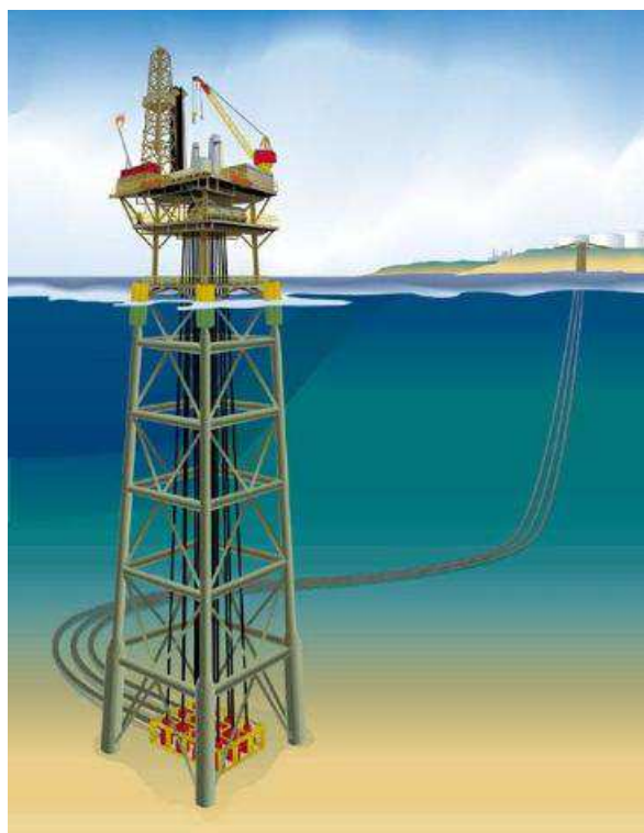
Figura 2.1 – Esquema de uma plataforma fixa tipo jaqueta (Fonte: Petrobras)
