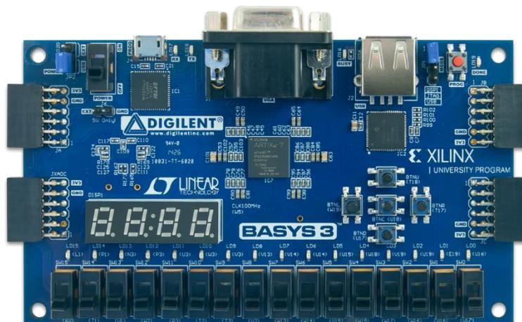
Figura 4.1. Placa de desenvolvimento FPGA Basys 3
