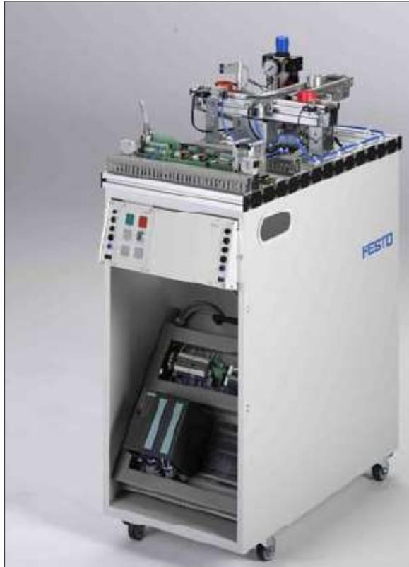
Figura 3.7- Estação de Separação (Festo didatic, 2006).
