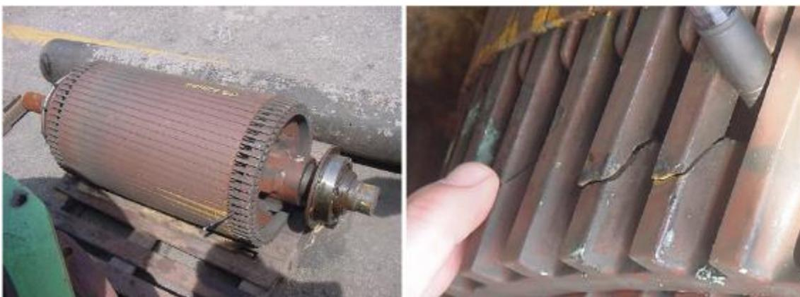
Figura 3.2 - À esquerda: rotor gaiola de esquilo de um motor elétrico. À direita: barra quebrada do rotor.
