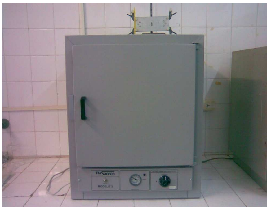
Figura 4.4 - Estufa utilizada durante todo o processo de síntese do MCM-41.
