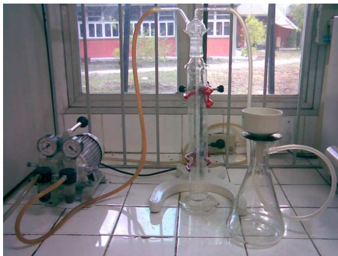
Figura 4.5 - Sistema utilizado para a filtragem e lavagem do MCM-41.
