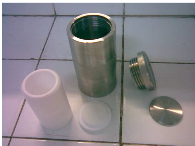
Figura 4.3 - Autoclave de teflon e aço utilizada na síntese do MCM-41.
