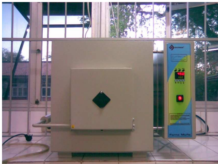
Figura 4.7 - Mufla utilizada na etapa de calcinação do MCM-41.
