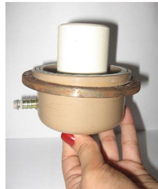
Figura 16: Detalhe da montagem do sistema filtrante
