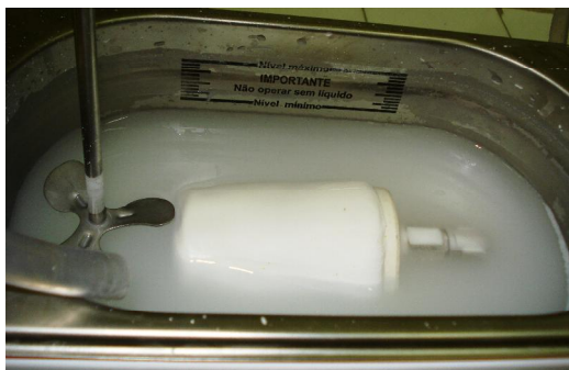
Figura 24: Torta formada na filtração ultrassônica de suspensão de \text{CaCO}_3
