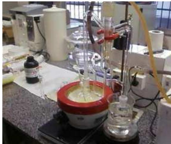
Figura 3: Esquema de destilação por Likens & Nickerson
