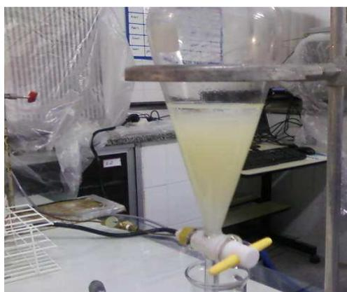
Figura 5: Esquema de extração líquido-líquido
