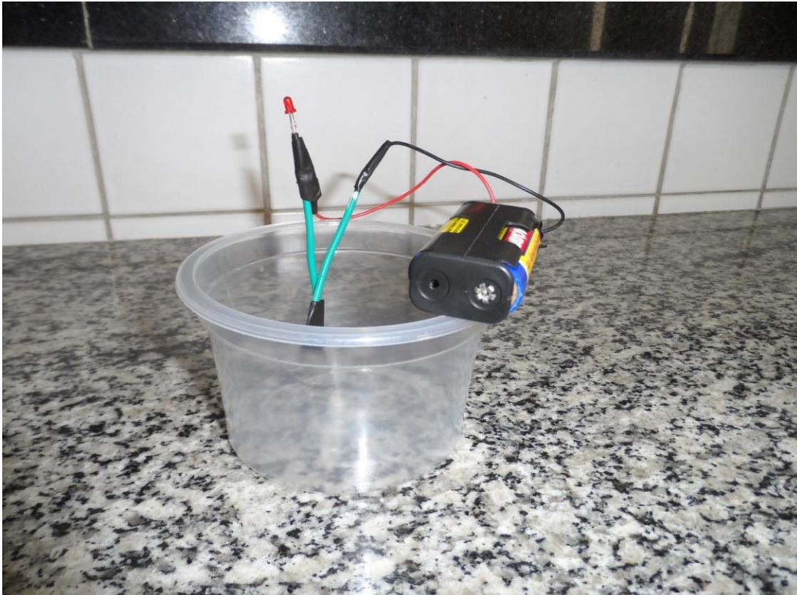
**Figura15:** Foto da aparelhagem utilizada no experimento de “Condutividade Eletrolítica”.
