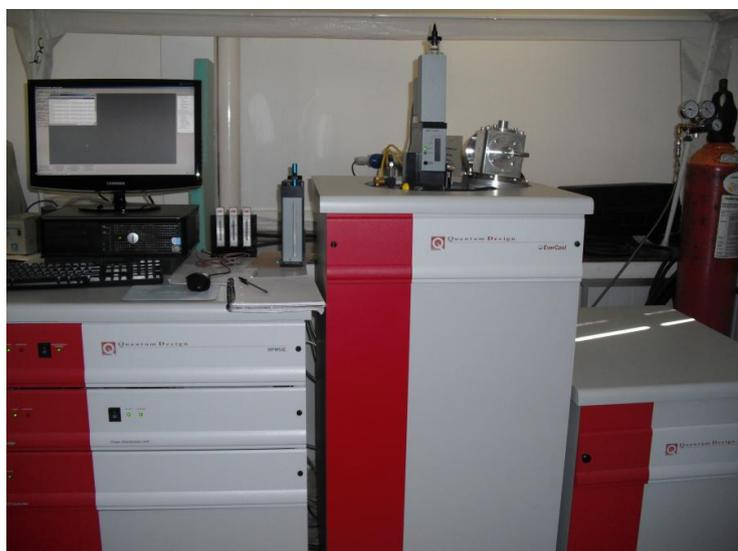
**Figura 4. 8:** Magnetômetro SQUID da *Quantum Design*.
