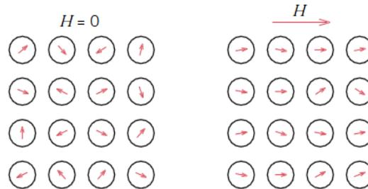
**Figura 2. 3:** Configuração de dipolo atômico sem e com campo magnético externo para um material paramagnético (CALLISTER, 2001).
