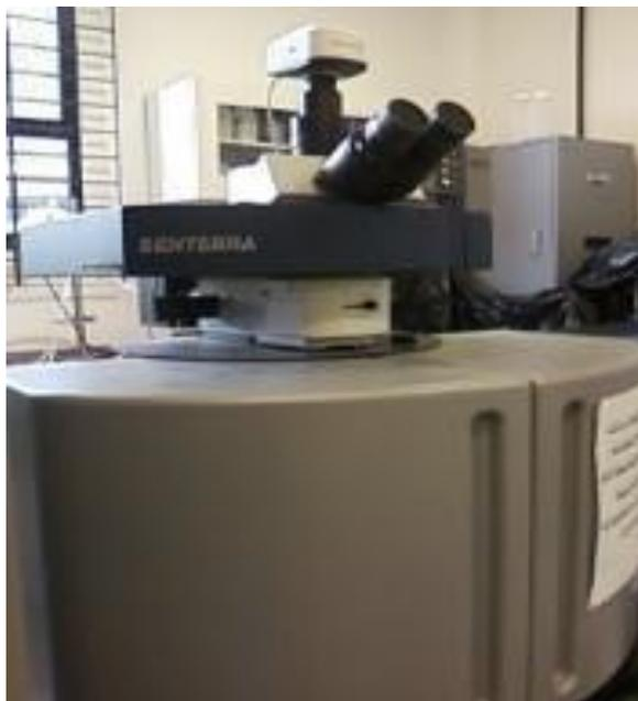
**Figura 4. 5:** Espectrofotômetro Senterra da Bruker.
